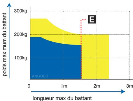
Si la longueur max du battant est supérieure à 1,5m ou si vous utilisez des modèles réversibles il faut installer l'électro-serrure pour verrouiller la porte en position de fermeture. La hauteur et la structure du vantail, ainsi que la présence de vent fort, peuvent provoquer la réduction des valeurs contenues dans cette table.
