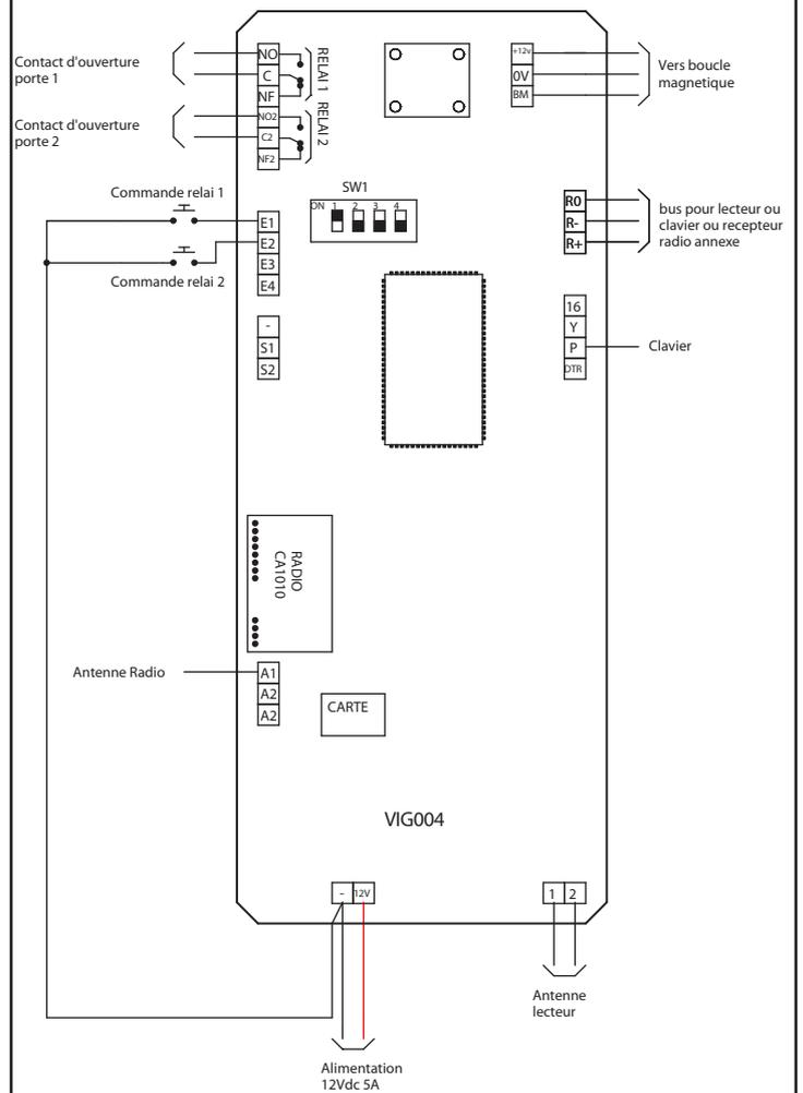
Schéma platine appel direct GSM gâche à émission
