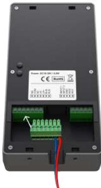
Utilisez le bornier 7P pour connecter la platine de rue. Connectez le câble à deux fils aux bornes BUS (la polarité n'a pas d'importance). Utilisez le schéma de câblage (pages 3, 4) pour connecter la serrure électrique et d'autres appareils.
