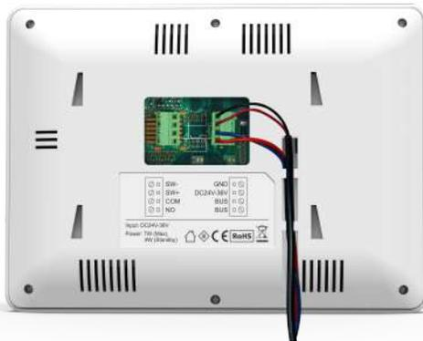
Pour connecter le moniteur, connectez un câble à deux fils aux bornes BUS (la polarité n'a pas d'importance). Connectez l'alimentation aux bornes, le fil noir à GND et le fil rouge à DC24-36V (Important ! Respectez la polarité).
